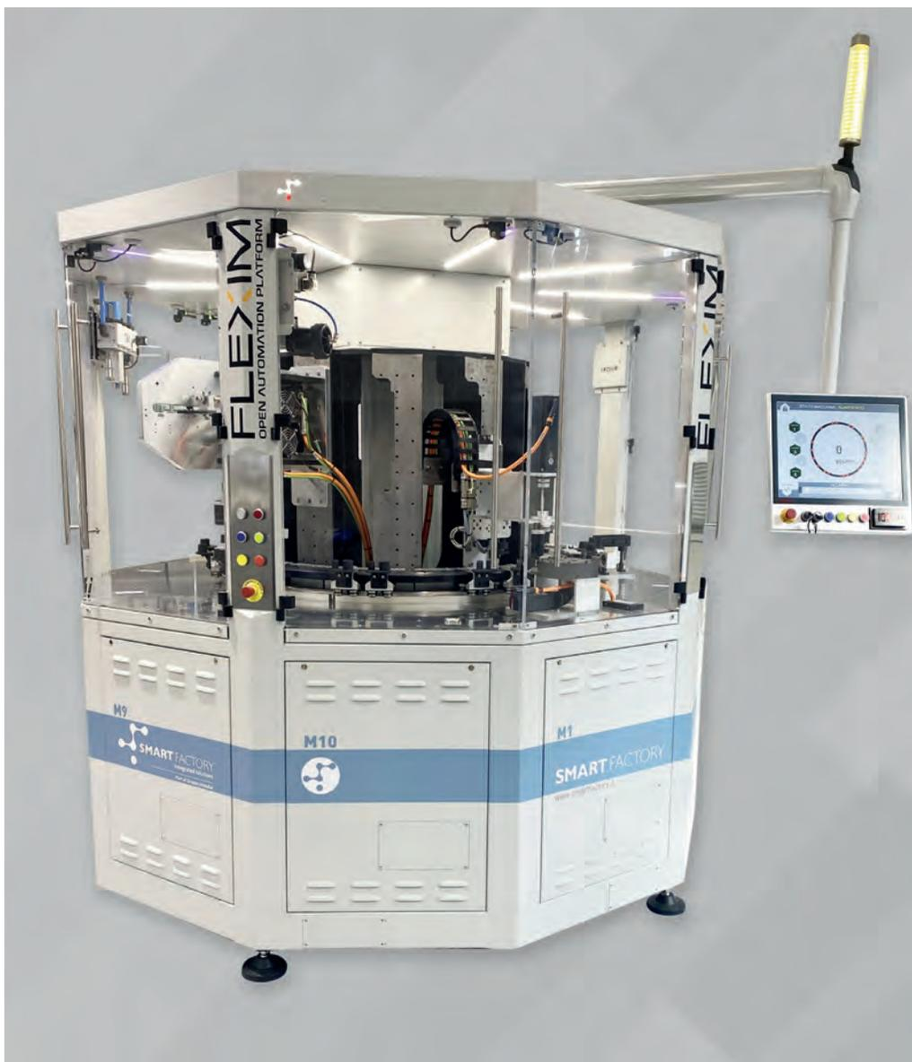
Smart Factory, parte del Gruppo Mondial, presenta *Flexim Open Automation Platform*, la sua piattaforma modulare. Integrabile con ogni tipo di stazione di lavorazione, da 6 fino a 20 nelle configurazioni a catalogo, può gestire più di 80 servo assi. Le personalizzazioni sono potenzialmente infinite, e possono essere effettuate sia in fase di set-up che attraverso integrazioni successive.
